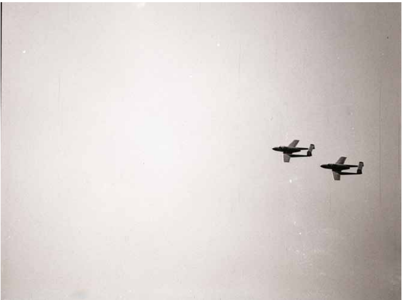
2 st J21R. Planen var konstruerade och byggda av SAAB. Ursprunget var J21 med skjutande propeller. Inför en förestående övergången till jetdrift ansåg sig SAAB behöva erfarenheter och fick detta genom att förse ett antal J21:or med jetmotor. 1950 fanns sådana plan på F10.
