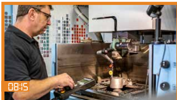
Sätter i och justerar ett nytt arbetsstycke i maskinen.
