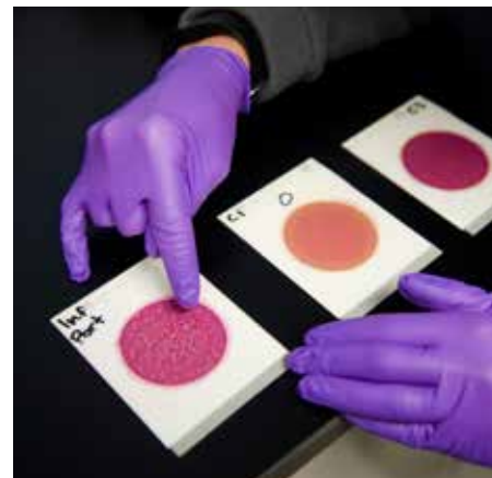
Laboratorietester visar hur olika varianter av Cleanit®-medier tar bort bakterier från vatten.
