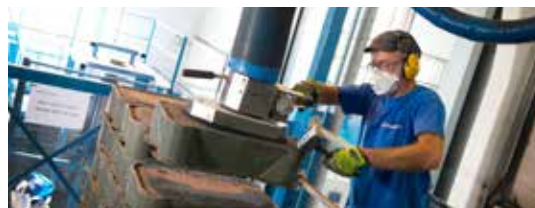
09:00 Adam använder en vakuumlyft för att lyfta trågen säkert och kunna knacka ut tackor av fast pulver ur dem. Tackorna fortsätter till en kross och trågen återanvänds.
