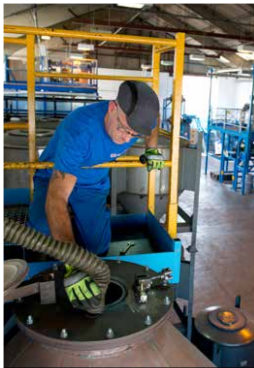
15:00 Adam står ovanpå en annan blandare i produktionsområdet för specialprodukter och rengör tätningen med en stoftsugare. Det får inte finnas stoft på tätningen när locket stängs.
