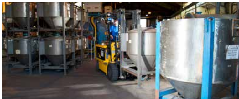
12:45 Förbereder blandning av olika pulversorter i Metrova-blandaren. Adam tar ut de pulvermängder som behövs och håller materialet i en stor matarficka som ansluts till blandaren.
