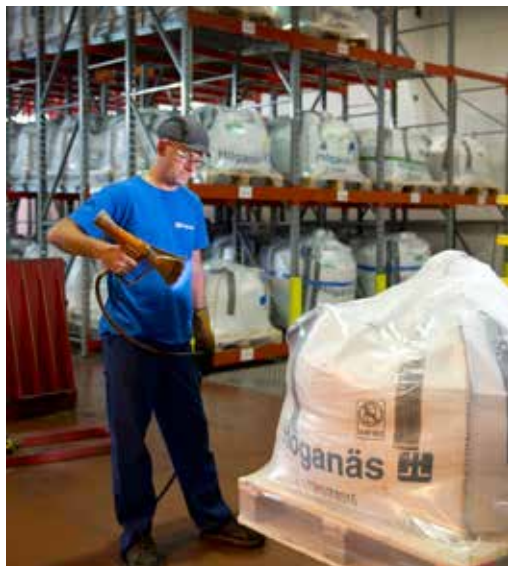
15:30 Adam använder en värmepistol för att krympa plasthöljet kring en storsäck fylld med metallpulver, innan den skickas iväg till en kund.
