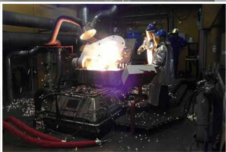
Atomisering av finpulver vid Pilot Centret i Höganäs. Vid anläggningen arbetar åtta personer och här finns småskaliga versioner av de flesta av Höganäs produktionsprocesser. Dessa används för att testa nya processer och produkter.
