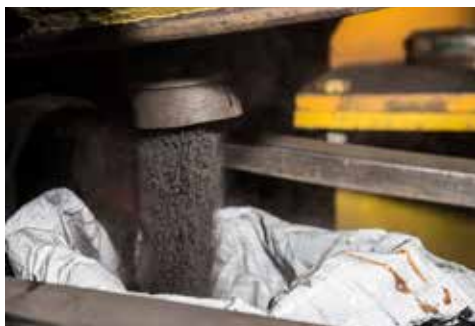
Rena järnpulver är basen för låglegerade blandningar för sinterstål.
