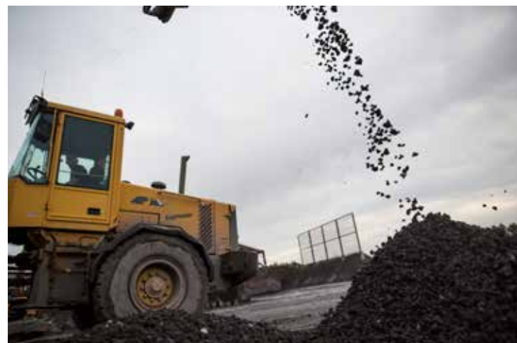
Efter siktning i tre slaggfraktioner av inkommande material från Höganäs, skickar Slaggprodukter AB resterande järn tillbaka till Höganäs atomiseringsanläggning för återanvändning.
