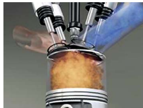
På bilden kan man se ventilsätesringar, som skyddar cylinderhuvudet mot extrem värme och förslitning.
