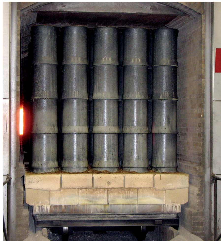
Svampverket har tre moderna tunnelugnar. Sligen packas i kieselkarbidkapslar med en reduktionsblandning runt om.
