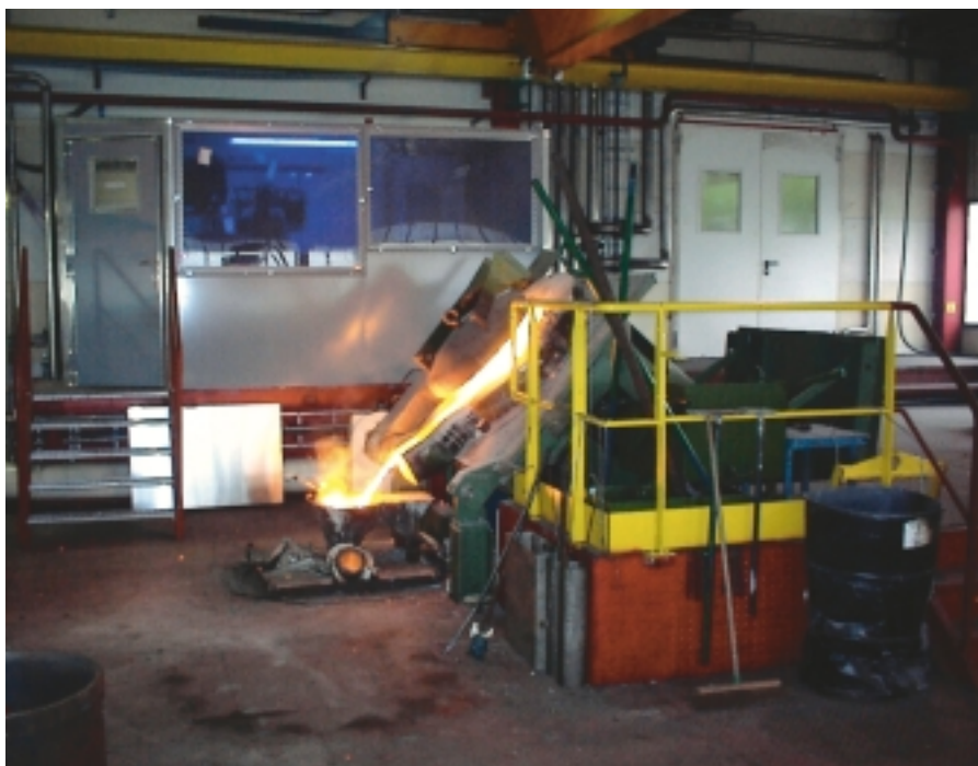
I förgrunden den nya induktionsugnen under atomisering. I bakgrunden det nya kontrollrummet för produktionslinjen för självflussande pulver.
