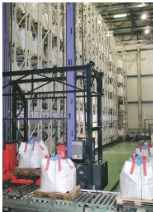
Saitamafabrikens automatiska höglager omfattar 4000 hyllplatser.
