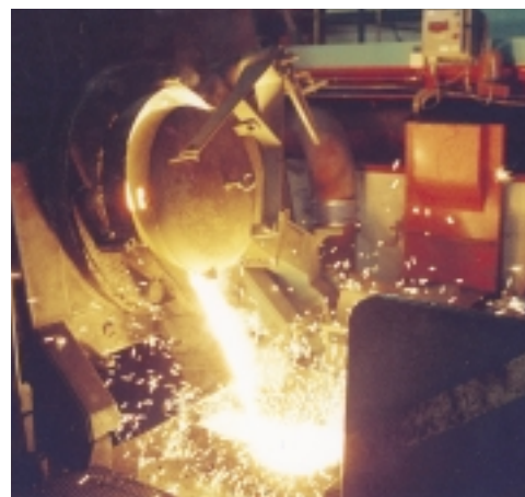
Smältprocess vid 1600°C i HOGAP-anläggningen.
