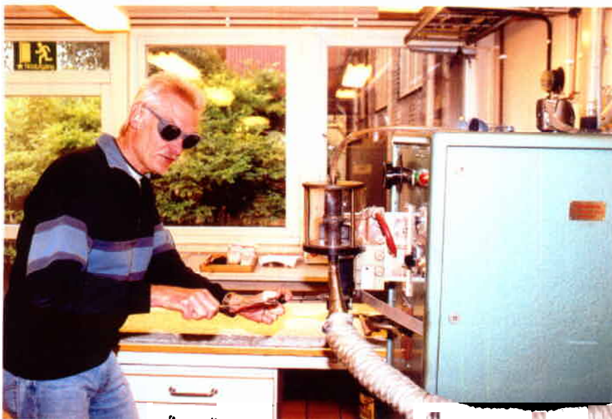
Från en induktionsugn tar Lasse Cronqvist ut en smältkropp som senare skall röntgenanalyseras.
