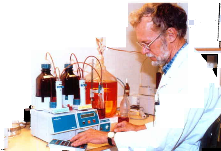
En sk potentiometer är ett av Willy Svenssons hjälpmedel vid manganbestämning.
