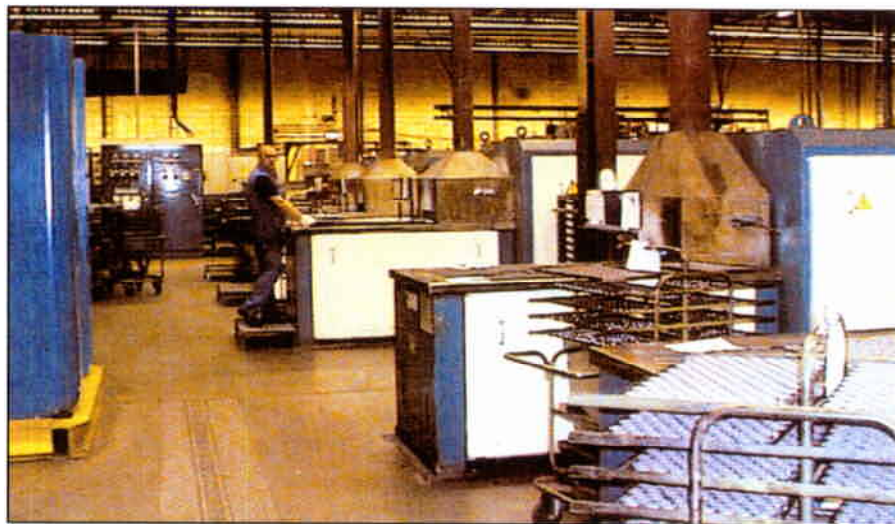
Monroes Sinter Metal Department har tolv högtryckspressar och sex sintringsugnar.
