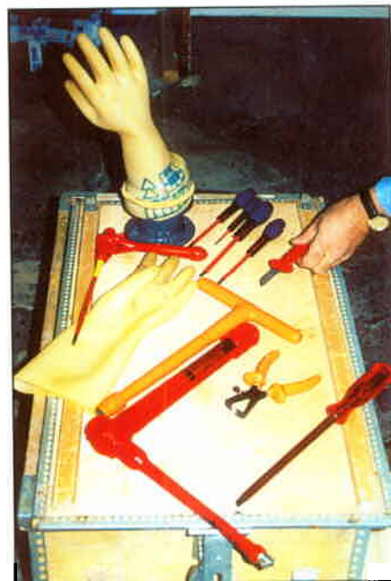
Personlig skyddsutrustning och verktyg för arbete med spänning.
