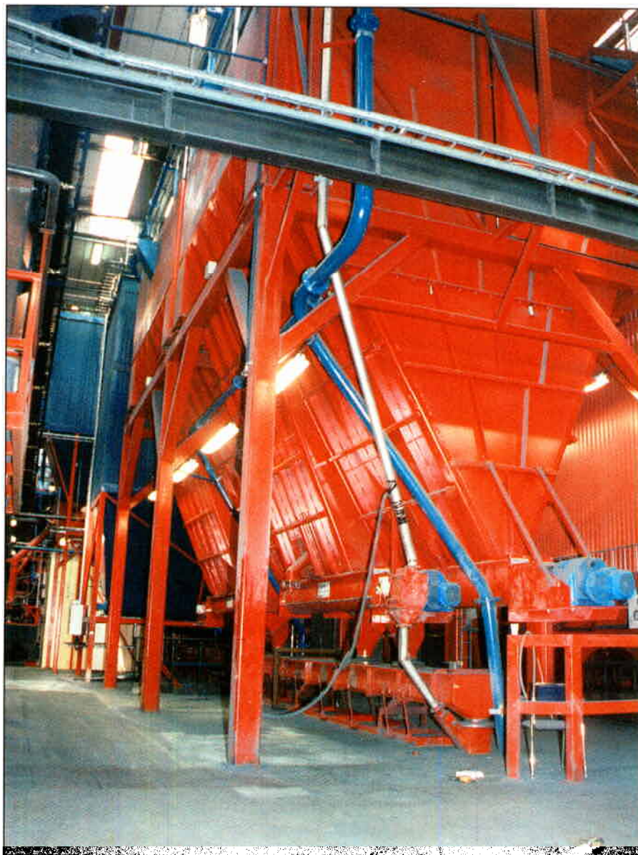
Den nya linjen är försedd med ny utrustning för vägning, krossning och mellanlagring.
