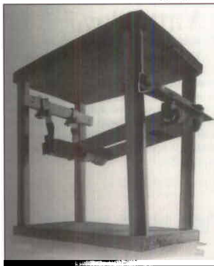
C F Petterssons modell för tryckrullsställ är Höganäsbolagets äldsta belönade förbättringsförslag.
