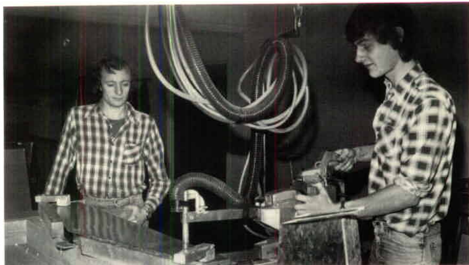
Bengt Pettersson och Mats Grunnegård svetsar brandventilatorer.
