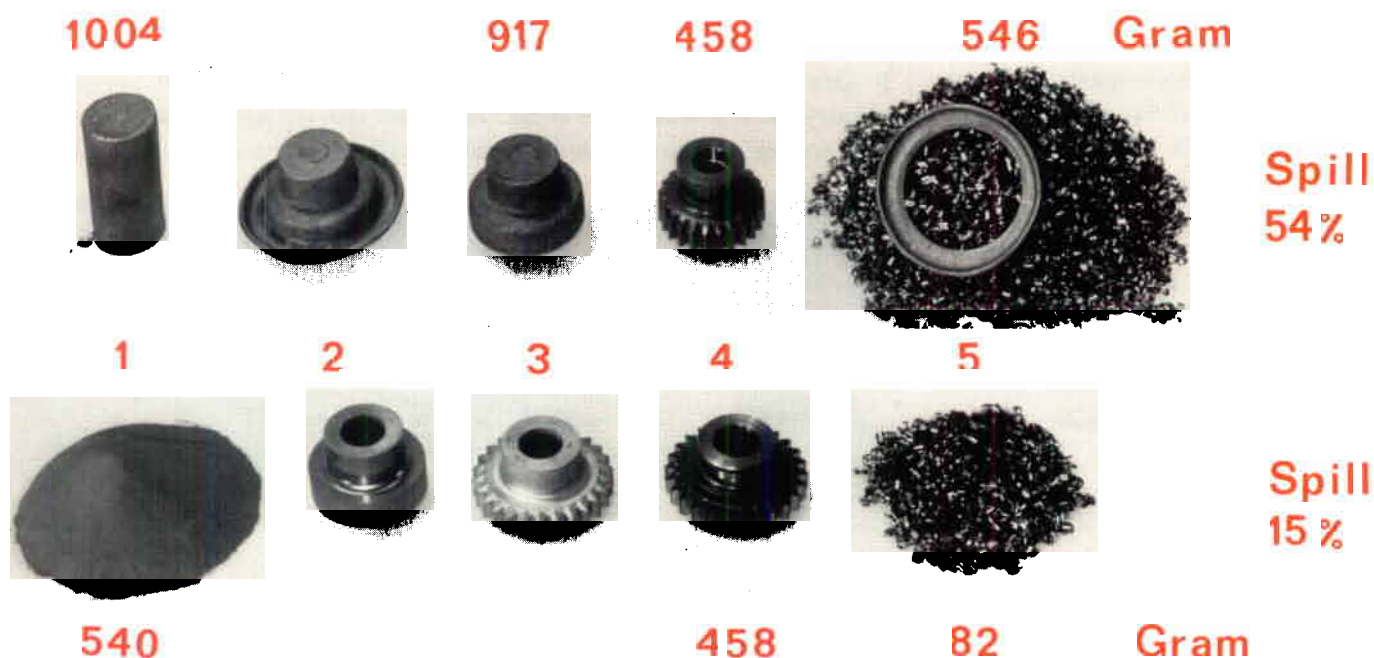
Bild 3. Jämförelse mellan tillverkningsgången enligt vanligt smide och enligt pulversmide för ett kugghjul till en personbilsväxellåda. Övre raden: Vanligt smide, 1) stålkuts, 2) samma kuts efter varmsmidning, sk "ämne med skägg", 3) ämnet efter bortstansning av "skägg", 4) det färdiga kugghjulet efter horrning, svarvning och fräsning, 5) spill.
