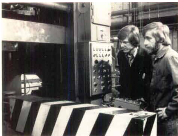
Stefan Hahne (t.v.) och Urban Björk (t.h.) övervakar den stora automatiska smidespressen (max. 400 ton presskraft) och utför samtidigt mätningar av presskraften under pågående smidning. Urban är bas för pulversmidesanläggningen och Stefan är ansvarig för att anläggningens invecklade elektriska styrsystem fungerar.
