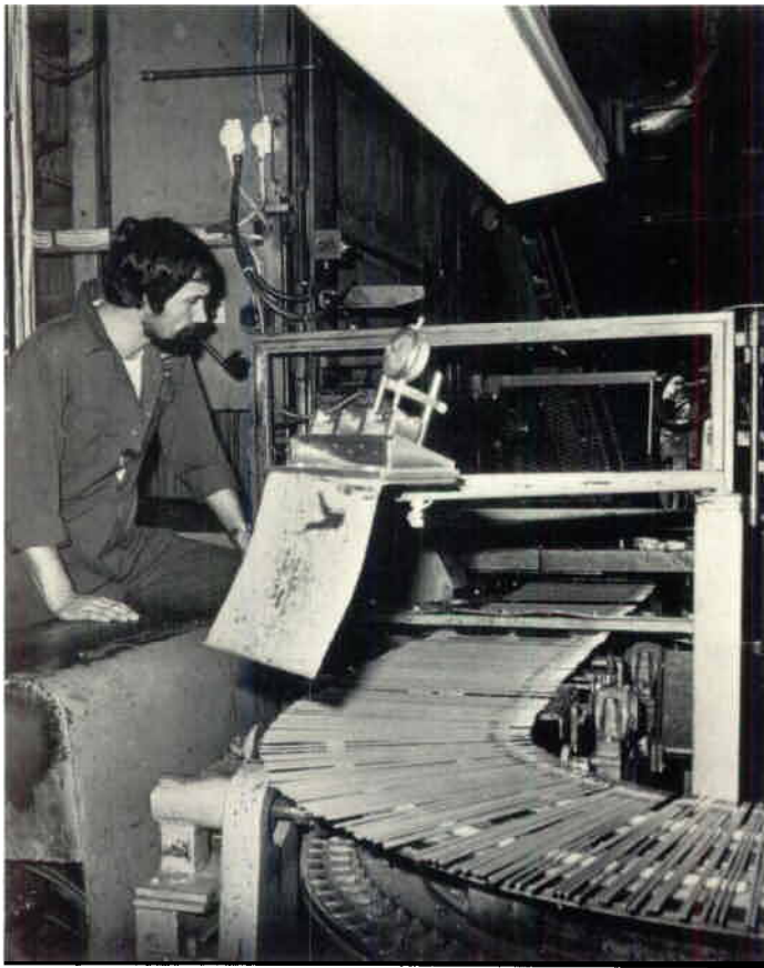
Kontroll av elektroder efter pressning (Esab, Perstorp)
