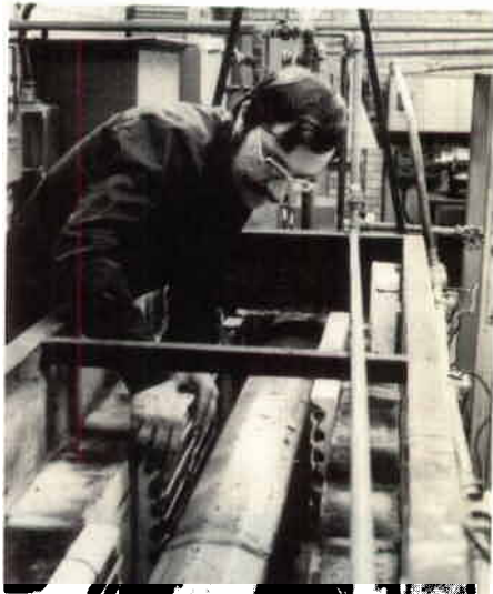
Olle Thornblad fick 7.100 kr för sitt förslag "Ändring av värmningsenhet på bandugn". Här byter han element i ugnen. Olle arbetar på metallurgiska forsknings- och utvecklingsavdelningen, Höganäs.
