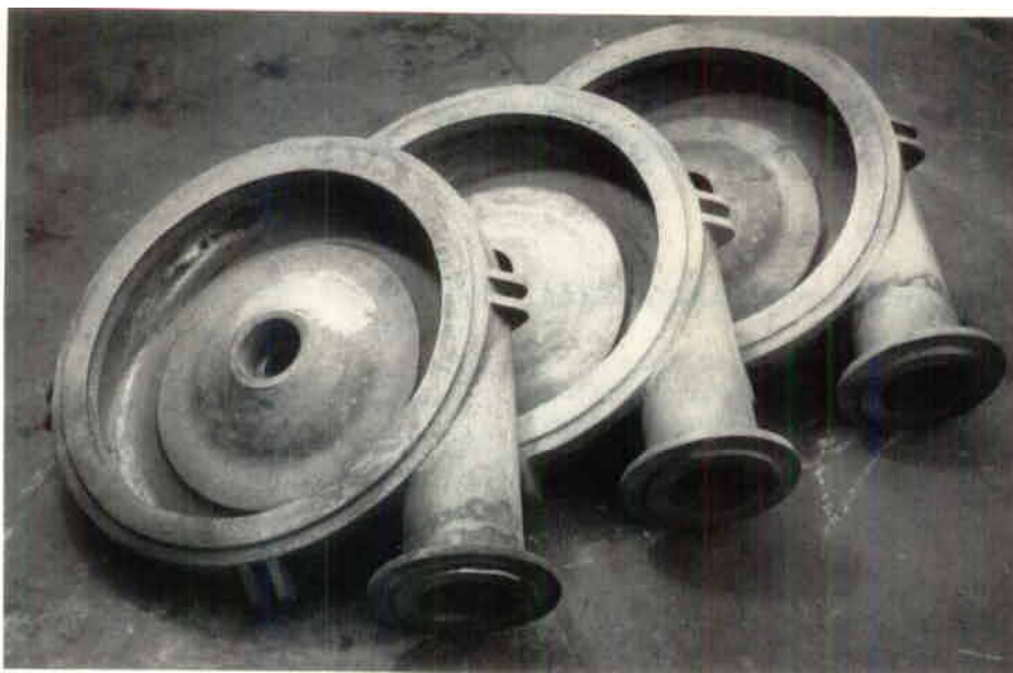
Pumphus hörde till tillverkningen.
