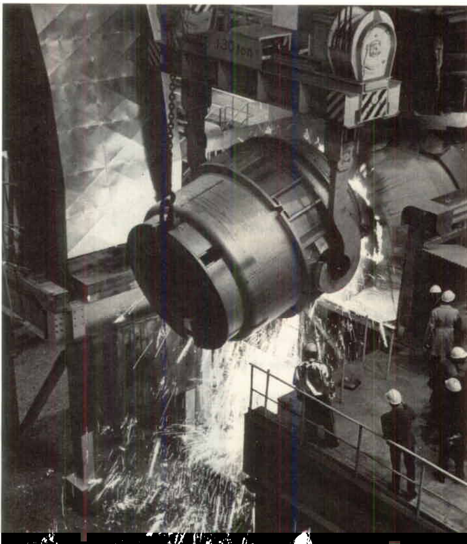
Itappning av råjärn i 35-tons-konvertern.
