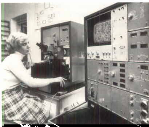
Monica Olsson mäter porositet i sintermaterial i TV-mikroskop.
