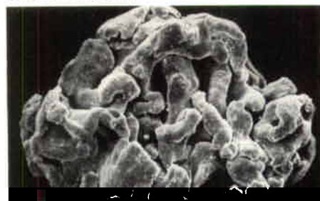
NC100.24-partikel i 2000x. Bild tagen i svepelektronmikroskop.
