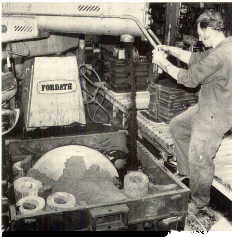
Edvard Vaverku fyller furanmassa på modellen och den ilagda järnsvampen.
