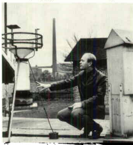
Jan Wängnerud kontrollerar utslaget av svävande stoft.
