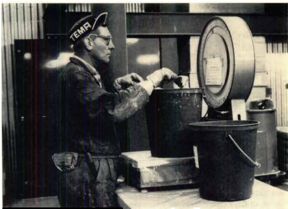
Vissa råmaterial till FSP-rör måste vägas upp i små mängder, enär de förbrukas i mindre kvantiteter. Bilden visar Claes Sandberg väga upp katalysatorpastan till polyesterhartset.
