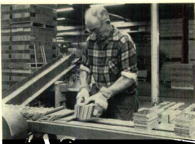
Sven Svensson buntar plattorna efter klyvmaskinen till sorterarna.
