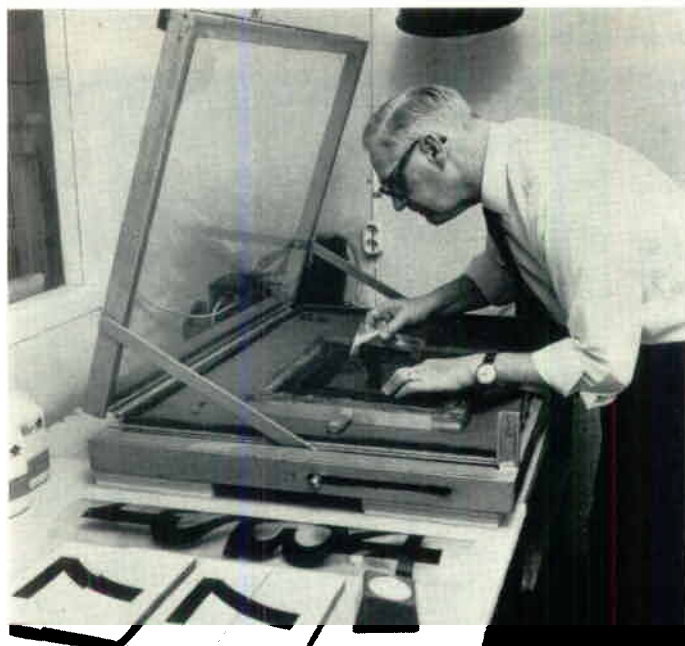
Belysning av fotoemulsion på skärmen.
