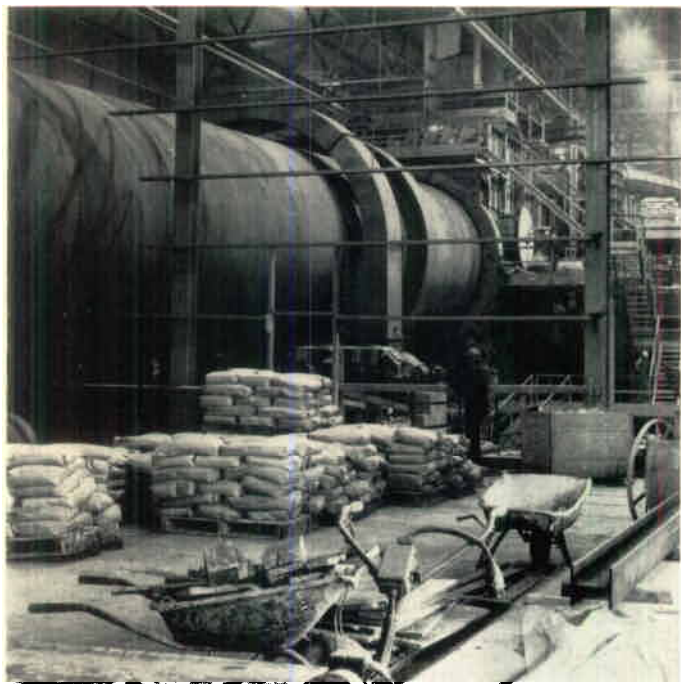
Roterugnen sedd från brännarplanet. I bakgrunden syns "Travelling grate".
