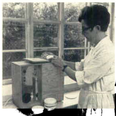
Med denna apparat kontrolleras and- ningsmotståndet i filterna.
