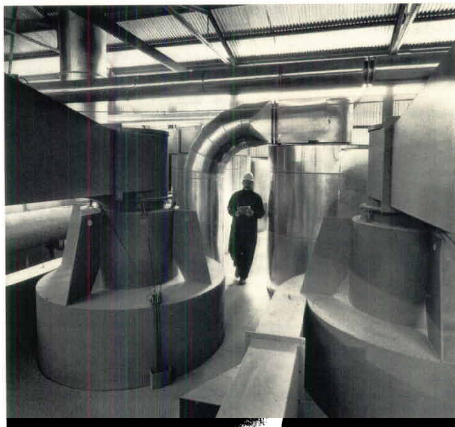
Ovan: Anriktningsverkets centrum kring Novorotorkvarnen. Ingenjörerna Kjell Björklund och Kjell Ekdahl diskuterar inkörningsproblem. — Nedan: Vindsiktarnas övre del. Ingenjör Lars Berg fångad i farten.
