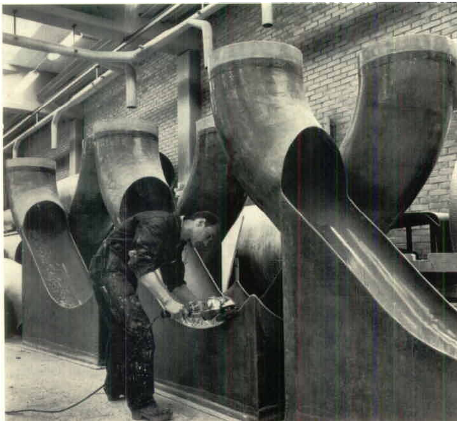
Höganäs tvätt- och sopnedkaströr i glasfiberarmerad polyester har blivit en eftersökt produkt, speciellt inom sjukhussektorn, där stora krav ställs på hygien. Klas Andersson, inom parentes Höganäs BK:s duktige målvakt, lägger sista handen vid ett tvättnedkast.
