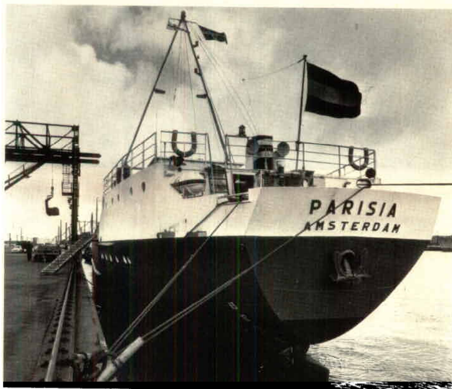
M/s PARISIA anlöpte på sin jungfruresa till Paris Höganäs hamn för att lasta järnpulver. Redan vid första anblicken ser man, att PARISIA inte är en vanlig båt, men så skall hon också gå under Paris broar. Därför kan styrhytten sänkas och masterna fällas.
