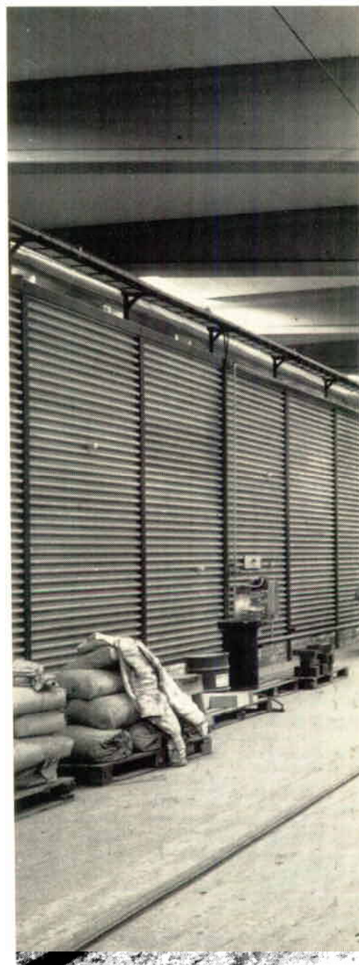
Ugnshallen i nya rörfabriken i Höganäs. Fabriken beräknas få en kapacitet av 18 000 ton glaserade lerrör per år. 1:a kvartalet 1964 avses som inkörningsperiod.
