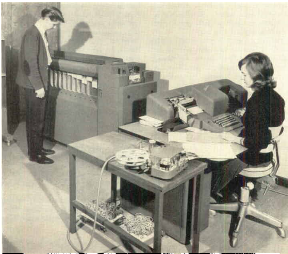
Remsovandlaren med "filmhjulet" i bildens förgrund styr hålkortsstansen, som automatiskt stansar och bläddrar fram hålkorten under uppsikt av Eivor Paulsson. — T.v. Marco-Pauli Lundgren vid sorteraren, som sorterar 42 000 hålkort i timmen i 12 olika fack åt gången.
