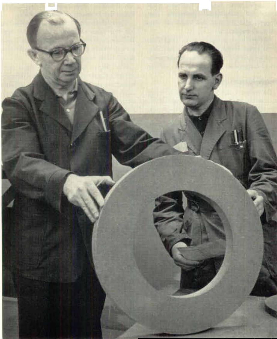
Martin Andersson och Åke Nilsson avsynar en centerlesslipskiva
