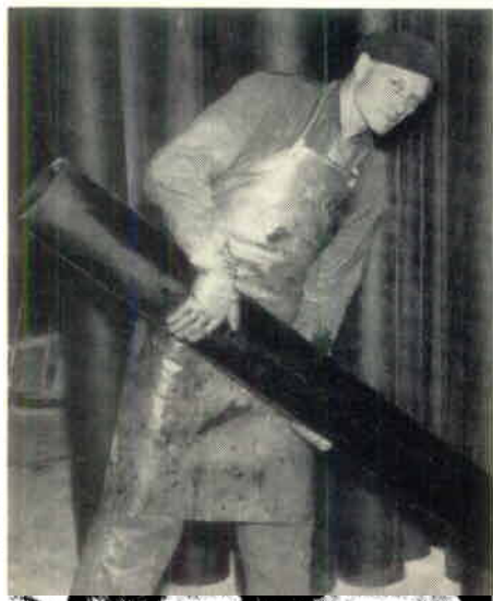
Det behövs inte en gruvkarls styrka att hantera dessa glasfiberarmerade furanrör. Pressning av dylika är nu förre gruvarbetare Gustav Lindströms uppgift.
