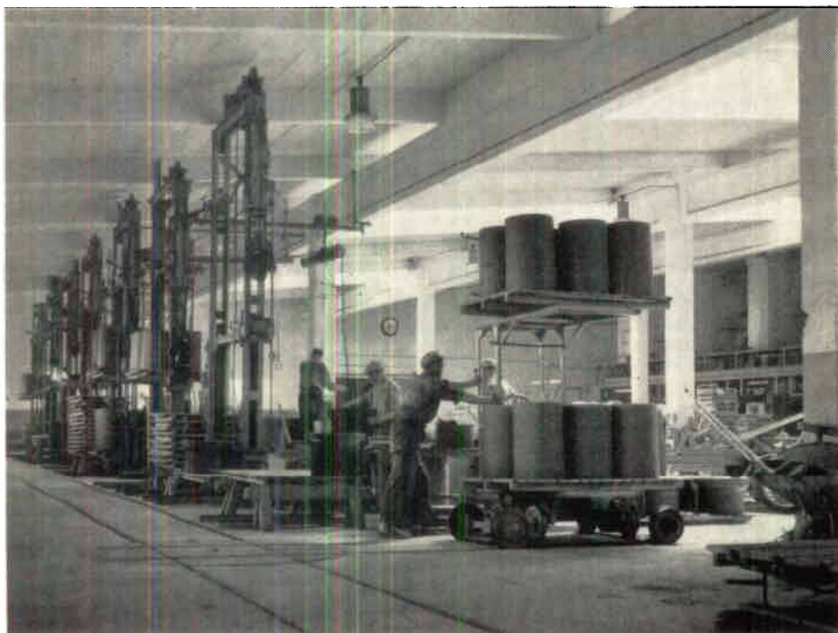
Geräumigkeit, Licht und Farbenwahl tragen zu angenehmen Arbeitsverhältnissen bei. Der Pressenraum in der Fabrik für glasierte Tonröhren (oben) ist sehr hoch und gut ventiliert.
