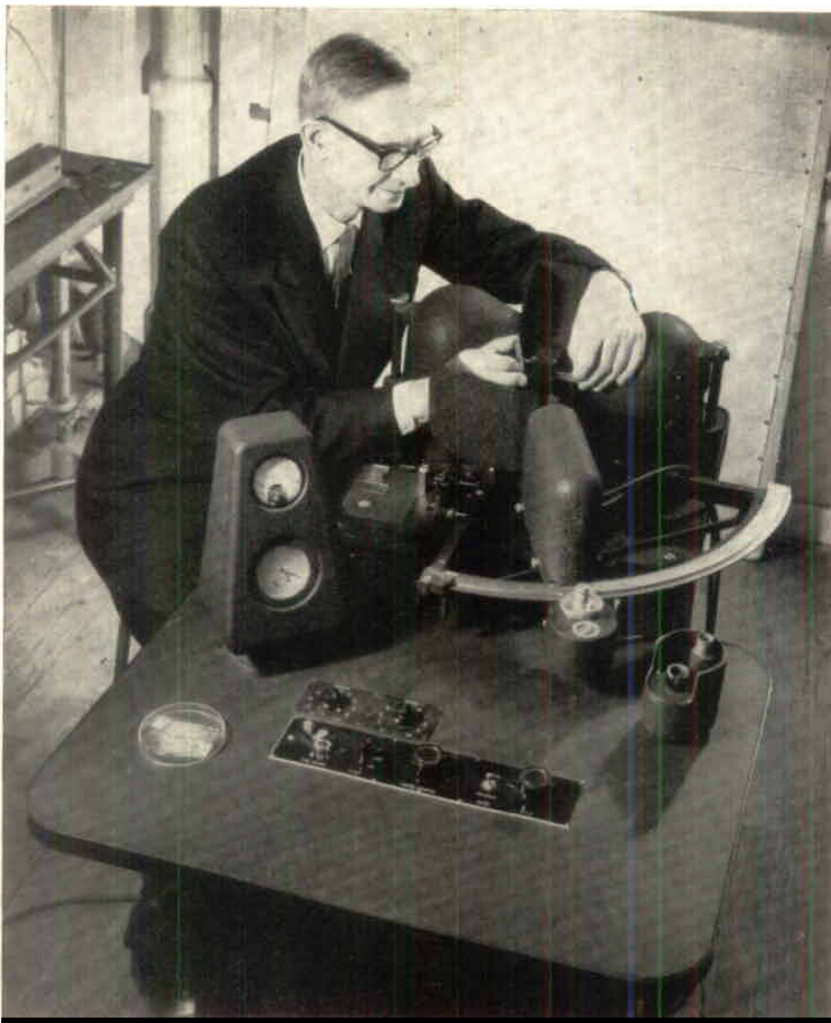
Med denna röntgenspektrograf undersöker professor Villem Koern ett materials finstruktur
