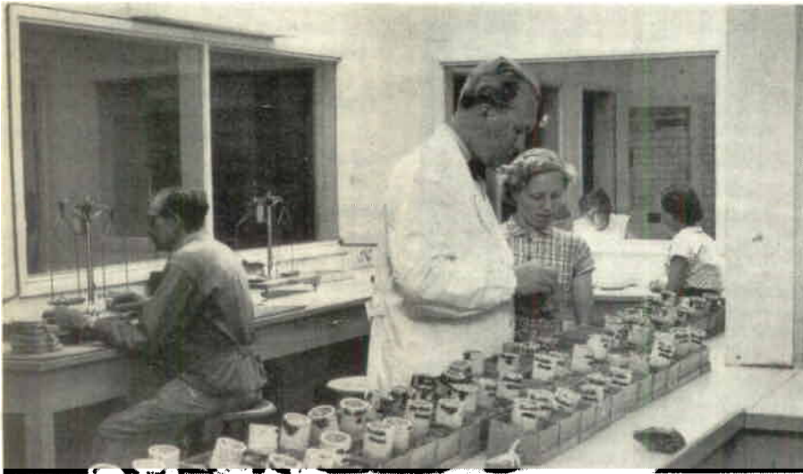
Bild 6. Keram. ingenjör Onni Dahl utför vid Skrombergverkens laboratorium preliminär bedömning av leror från ett borrhål. Hans medhjälpare vid registrering och arkivering är fru Inga Hansson, Ella Wallin och Briff Kvist. T.v. håller John Johansson på med vägning av provplattor.
