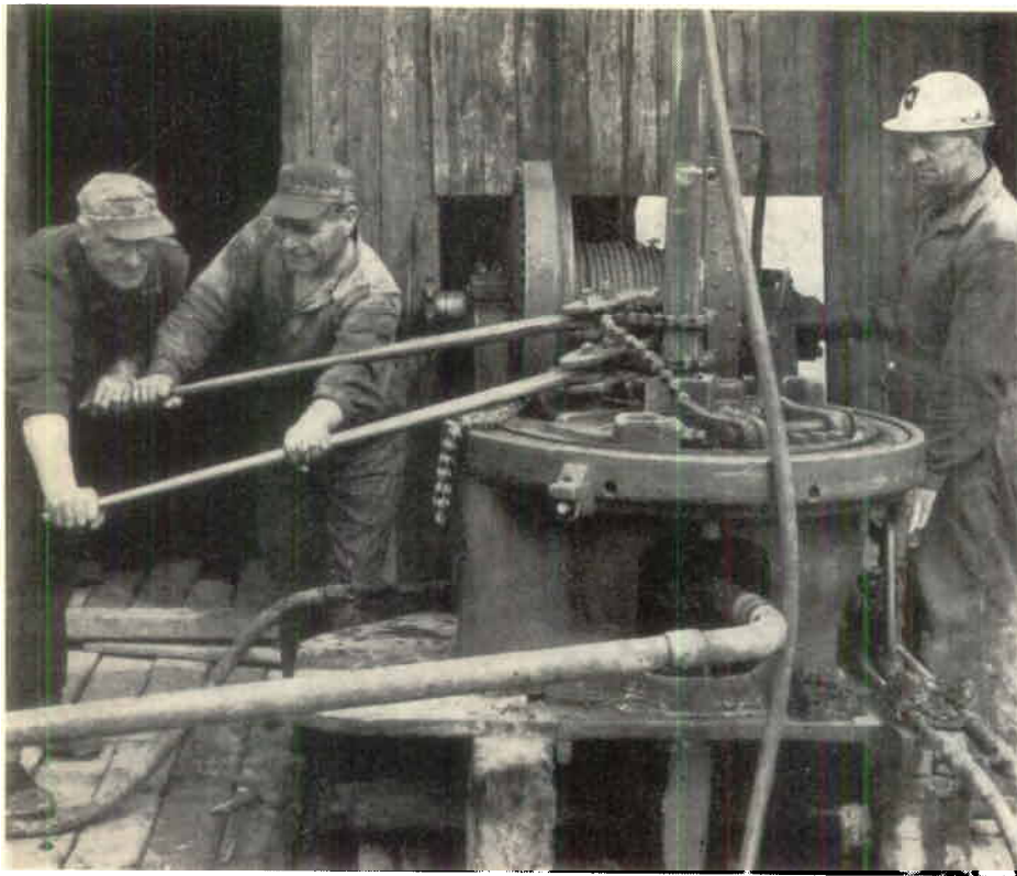
Bild 3. Karl Pålsson och Albin Lundblad spänner fast borret vid borrstängan i kärnborrmaskinen. Basen Erik Johansson kontrollerar arbetet.
