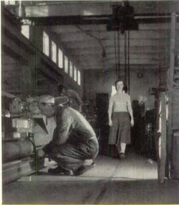
Gösta Pettersson monterar hydrauliska cylindrar för nya stensågsvagnar. Unga damen i sammanhanget är inköpsavdelningens Mary Gustafsson, på väg till halvdaysjobbet som biträde på centralförrådet.
