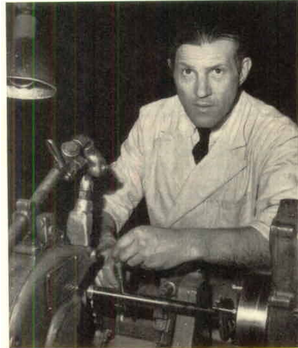
Vid en rundslipningsmaskin prövar sliplaboratoriets serviceman, Sven Eriksson , lämpligaste slipförfarandet för en vals av specialstål från Sandvikens Jernverk .
