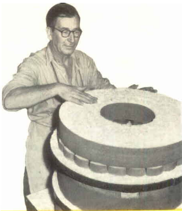
Ordföranden i Västerviks nya lokala samorganisation, Sölve Johansson, lägger skyddande eldfast sand mellan slipskivorna, innan de går igenom sitt elldop i tunnelugnen.
