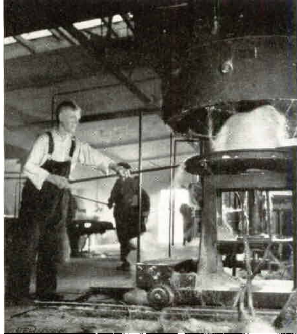
Herr Hj. Wendel hanterar skickligt sin »högaffel» och skär med den av en glasulls-»pasma», när tillräckligt mycket därav bildats. Sedan flyttar han över glasullen från slungmaskinen antingen direkt till skålmaskinen, som på bilden skymtar bakom hans rygg, eller till en vagn, som för glasullen vidare till någon annan avdelning.
