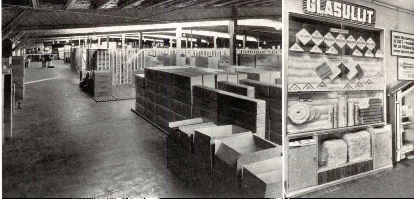
T.v.: En del av det stora lagret av färdiga Glasullit-produkter. I förgrunden syns kartonger med Glasullit-skålar, bakom spjalorna ligger paket med mattor och mantlar. Lagerbyggnaden är isolerad med Glasullit byggnadsmattor — naturligtvis. På bilden syns de mellan takbjälkarna. T.h.: En monter på Glasullsbolaget, som visar de olika färdiga Glasullit-produkterna.
