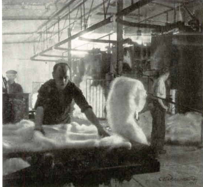
Det parti av skålmaskinen, där glasullen placeras. Herr Harry Rosenqvist breder ut glasullen i ett jämnt och lagom tjockt skikt, ett arbete, som kräver stor omsorg och påpasslighet.
