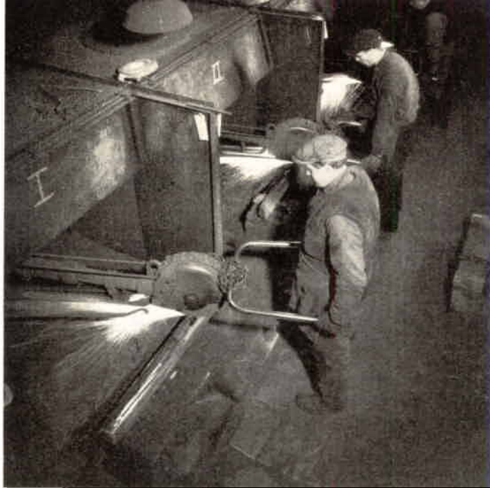
Fig. 14. "Skrotslipning" i pendelslipmaskin av ämnen vid ett svenskt stålverk med 16" konstharts-(bakelit-)bundna ALUMO-skivor från Västervik.
