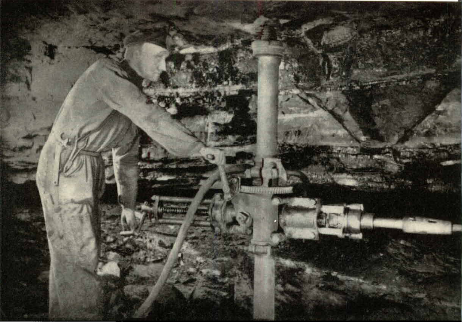
På hundra meters djup ligga de brytvärda kol- och lerflötserna i Schakt Gustaf Adolf, Höganäs. Under öronbedövande larm arbetar sig förskrämningsmaskinens borrar allt djupare in i orten.
