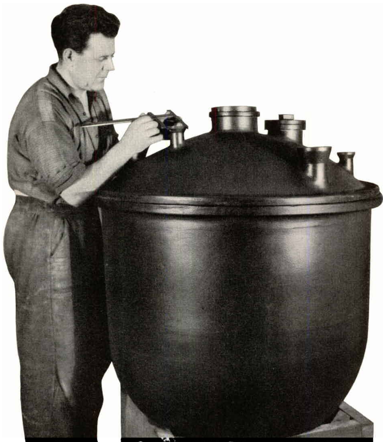
Det mesta syrafasta stengodset tillverkas för hand. Hugo Holm kontrollmäter här ett syrafast omrörarekär, en komplicerad och dyrbar pjäs. Höganäs.
