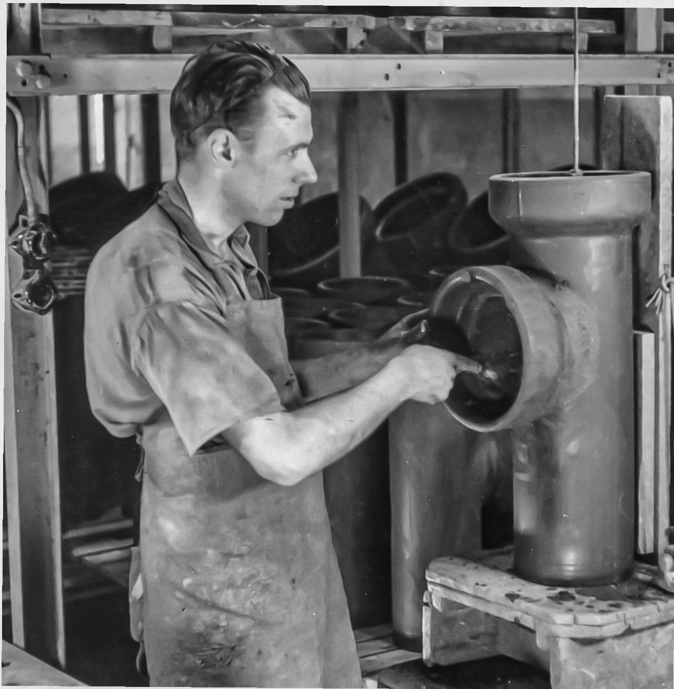
Karl Andersson monterar ett grenrör. Säkert öga och skicklig hand äro nödvändiga egenskaper vid detta arbete.
